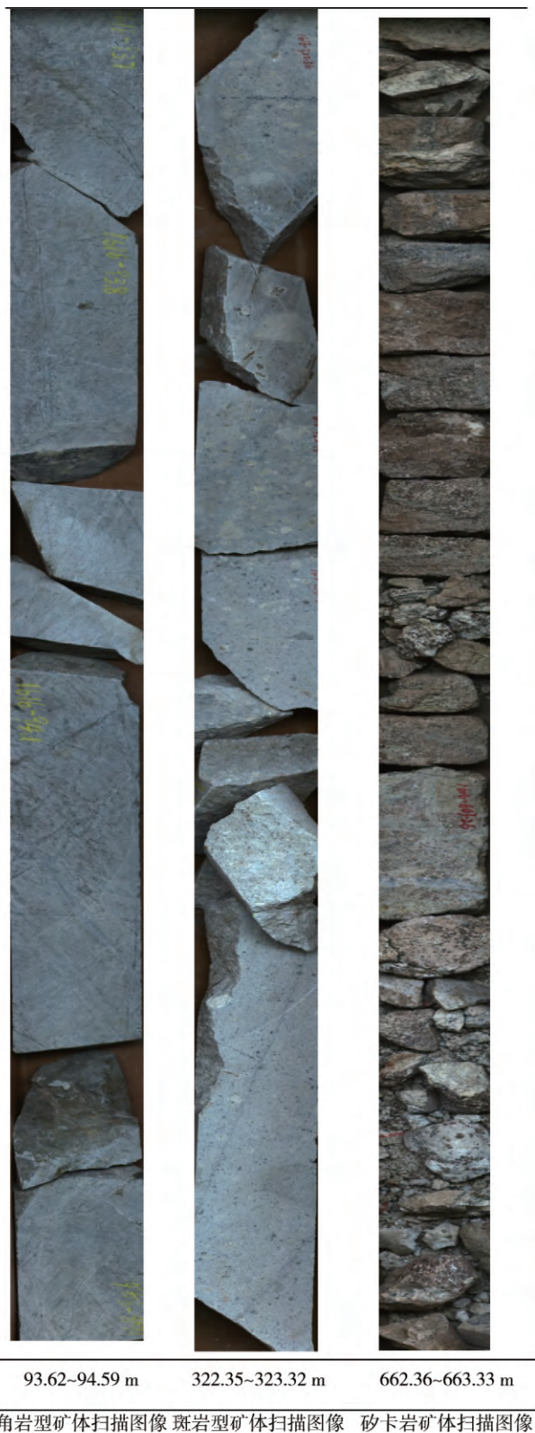
图2 ZK1616 岩芯白光扫描钻孔柱状图
